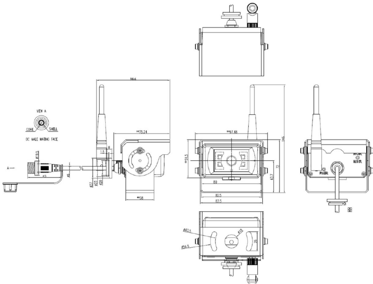
Automatisches Pairing mit Funkempfänger 730032 oder Funkmonitoren 573407 und 573410 in den ersten 60 Sekunden nach Erstinbetriebnahme. Zusätzlicher Pairing Knopf an Rückseite der Kamera.
